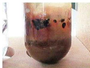
実験：くぎを 80 倍希釈液と水道水に同時に浸し 88 日後の結果
